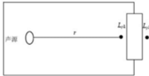
图 6.2-12 室内声源等效为室外声源图例
